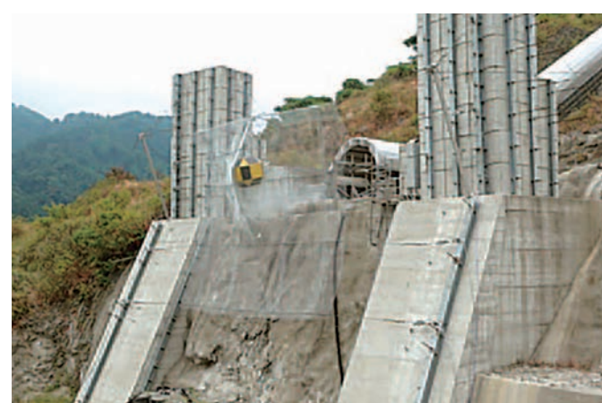
支柱に重錘を衝突させる実験
