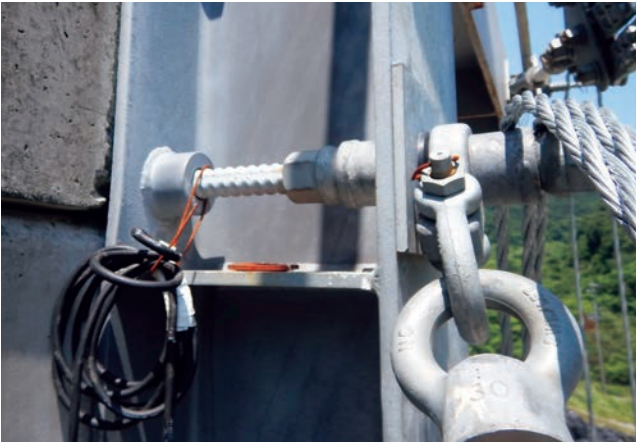
左写真の実験終了後アンカー部 (変形・破損等は無し)
