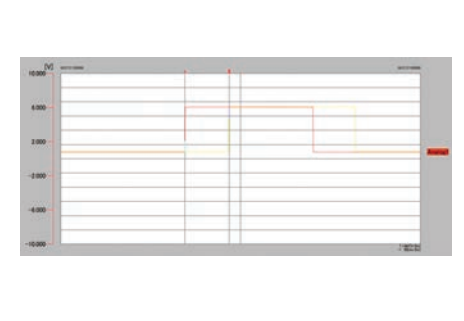
レーザーによる重錘衝突速度測定結果
