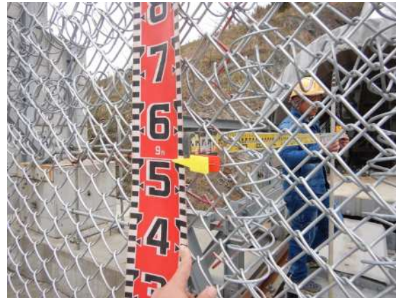
重錘衝突位置確認
